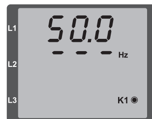
Beispiel 2: Abb. Keine Drehfeldrichtung festgestellt.
