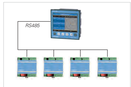
Abb.: Die Anbindung der I/O-Feldbusmodule erfolgt über die Schnittstelle RS485 des UMG-Messgerätes
